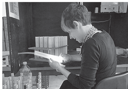
Bild 6: Starke Kontraste entstehen z. B. auch bei Kontrollarbeiten mit hellem Lampenlicht in dunkler Umgebung.
