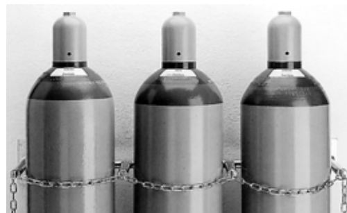
Bild 1: Sicherung der Druckgasflaschen mit Ketten
