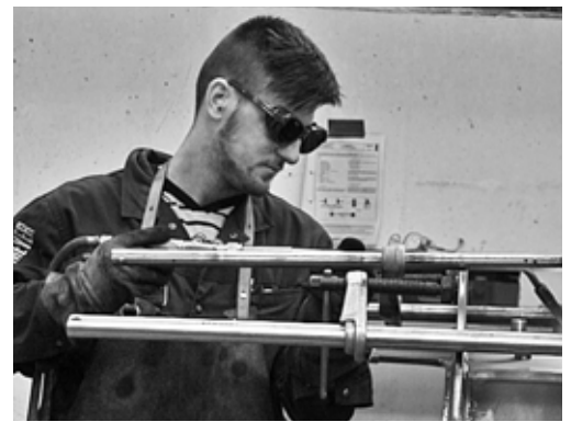
Bild 5: Gasschweißer beim Verputzen, mit Schweißerschutzbrille (Schutzstufe 4–7 nach EN 169) und Gehörschutz
