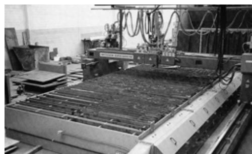
Bild 3: Brennschneidanlage mit Werkstückabsaugung (Mehrkammer-Absaugsystem)
