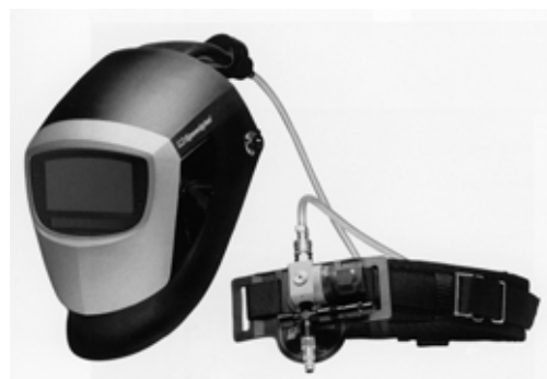
Bild 4: Beim thermischen Schneiden und Flammwärmern in engen Räumen oder schlecht gelüfteten Bereichen (z. B. in Behältern, Leitungen) muss ein Druckluft-Schlauchgerät in Verbindung mit einem Schweisserhelm getragen werden.
