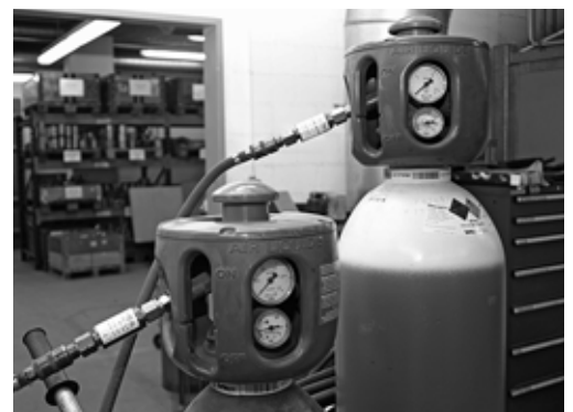
Bild 6: Stahlflaschen mit Schutzkappe, integriertem Druckminderer, Druckregler, Gasinhaltsanzeige und Sicherheitseinrichtung
