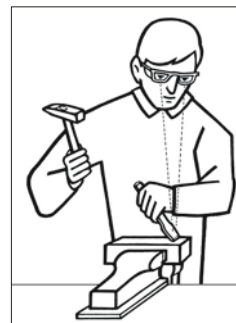
Bild 9: Richtige Arbeitsweise beim Meisseln: Werkstück in Schraubstock eingespannt, Hammer richtig gefasst, Blick auf die Meisselschneide gerichtet, Schutzbrille.
