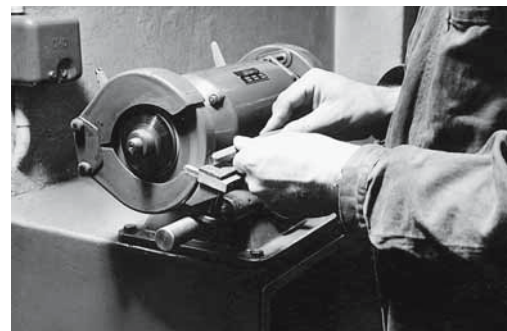
Bild 6: Schon die kleinsten Brauen an Meisseln sind abzuschleifen. Die Schlagflächen der Köpfe sind leicht zu runden und anzufasen.
