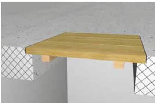
1 Kleine Bodenöffnung in der Fläche mit eingelegten Brettern
