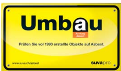
1 Vor Arbeitsbeginn müssen Objekte, die vor 1990 erstellt wurden, auf Asbest geprüft werden.
