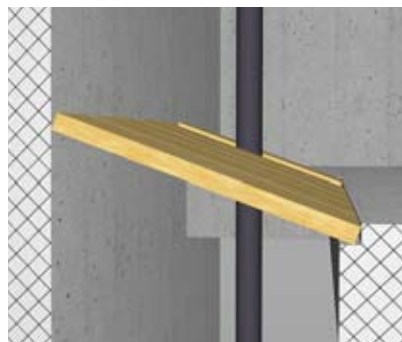
2 Kleine Bodenöffnung im Wandbereich mit verkeilt Brettern
