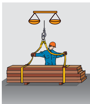
2 Wird das Transportgut in ausbalancierter Lage angeschlagen?
