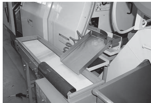
Bild 3: Teileaustragung mit Förderband
